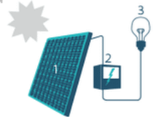
1. Zonnepaneel | 2. Omvormer | 3. Elektrische toestellen
